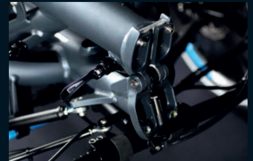
Solides Falgelenk von HP VELOTECHNIK mit selbsttätig einrastender Sicherungsfalle. Edelstahl-Präzisionsachse.
