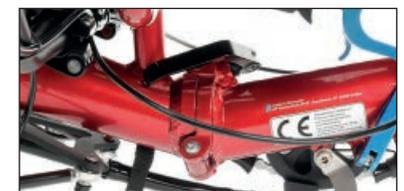
Doppelte Sicherheit: Das robuste faltgelenk verfügt über einen Sicherungsbolzen, der nach dem Lösen des Schnellspanners gegen Federdruck entriegelt wird. Präzisions-Faltachse aus Edelstahl von HP VELOTECHNIK.
