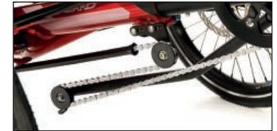
Mit der optionalen Rahmenschnellverstellung kann die Länge noch schneller eingestellt werden. Die Kettenlängenänderung wird mit leichtgängigen Umlenkrollen kompensiert. Durch Einschieben des Tretlagerauslegers beim Transport wird Ihr Gekko fxs damit noch kompakter.
