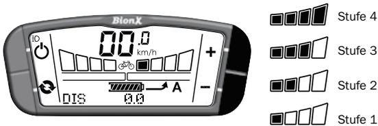
Ausgehend vom Fahrrad-Modus () drücken Sie für mehr, und für weniger Motorunterstützung
