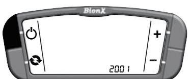
Durch Drücken der -Taste bestätigen Sie die eingestellte Ziffernfolge, und kehren zur Standardanzeige zurück.
