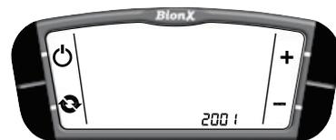
Drücken Sie oder um zwischen den Ziffern 0-9 zu wählen. Bestätigen Sie die Auswahl mit . Diesen Schritt wiederholen, bis der gewünschte Code angezeigt wird. Drücken Sie um den Vorgang erneut zu durchlaufen.
